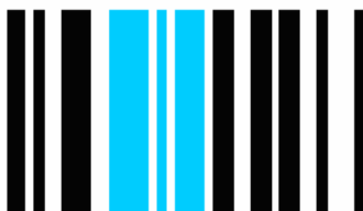
Uitvergroot eerste gedeelte van een GS1-128 barcode met het FNC1-teken in het blauw
